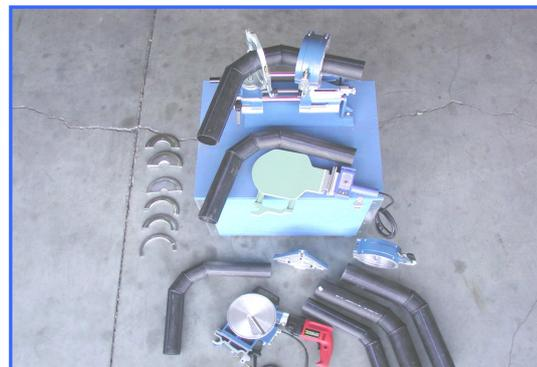
**Las abrazaderas pivotantes permiten la construcción de codos segmentados en diferentes radios, sifones y piezas especiales.**
